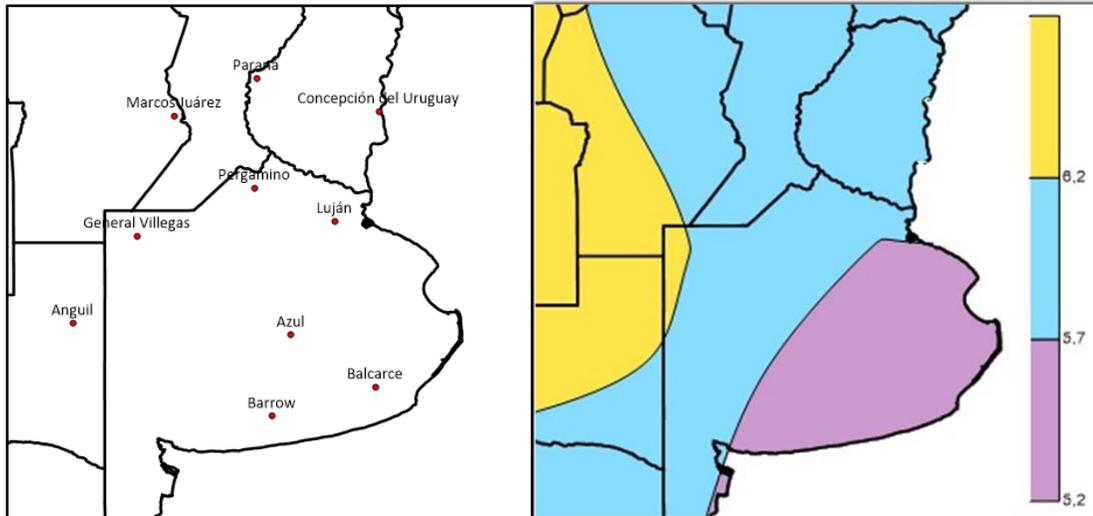
*Figura 2: Izquierda: estaciones de medición de la red del GERSolar. Derecha: Mapa de irradiación solar diaria media mensual correspondiente al mes de marzo de 2018 (los valores están en kWh/m<sup>2</sup>).*
